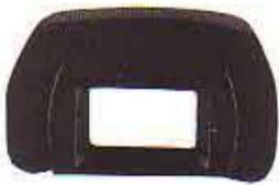
Die Augenmuschel F-3 wird mit ihrer Schnappsicherung auf die Okularfassung gesteckt und verhindert den Einfall von Streulicht in den Reflexsucher, so daß Fehlbelichtungen im Automatikbetrieb ausgeschlossen sind. Sie behindert die Kamerarückwand nicht und nimmt FL-Dioptrienlinsen (+3 dpt bis -5 dpt/Zubehör) auf.
