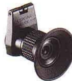
Diese Hochleistungslupe erleichtert die präzise Fokussierung, insbesondere bei Nahaufnahmen. Sie vergrößert die Bildmitte 2,1fach. Ein Adapter gestattet die Verwendung sowohl an rechteckigen als auch an runden Okularen. Die Dioptrieneinstellung ist von -5 dpt bis +3 dpt möglich. Das optische System besteht aus vier Linsen in zwei Gliedern.
