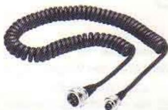
Stellt die Verbindung zwischen PMD und PMD-Batterieteil her. Empfohlen als Auslöseverbindung bei Stativaufnahmen oder bei mobilem Einsatz und gewichtsparender Trennung von PMD und Batterieteil. Spiralkabel, Stecker mit Schraubsicherung, Länge 100 cm.
