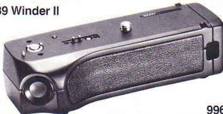
Die maximale Schaltfrequenz für den Filmtransport beträgt 2 Bilder/Sek. Die Wahl zwischen Einzel- und Serienaufnahme ist über den Camera-Auslöser möglich. Eine Besonderheit ist der zusätzliche elektromagnetische Camera-Auslöser, der für bequeme Auslösung bei Hochformataufnahmen sorgt. Weitere Details: Stromversorgung durch vier 1,5 V-Mignonbatterien, Funktionskontrolle über LED, Batterietesteinrichtung, EIN-AUS-Schalter, automatische Film-Endabschaltung.
