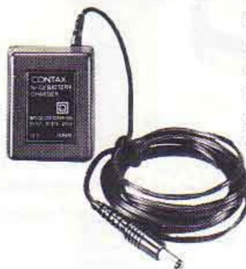
Wird gemeinsam mit dem RTW-Ladeadapter zum Aufladen der RTW-NC-Akkus verwendet. Die Ladedauer beträgt ca. 10 Stunden. Ist in drei Primärspannungstypen erhältlich: 100, 120 und 220 V. Sekundärstrom: 8,7 V, 45 mA.
