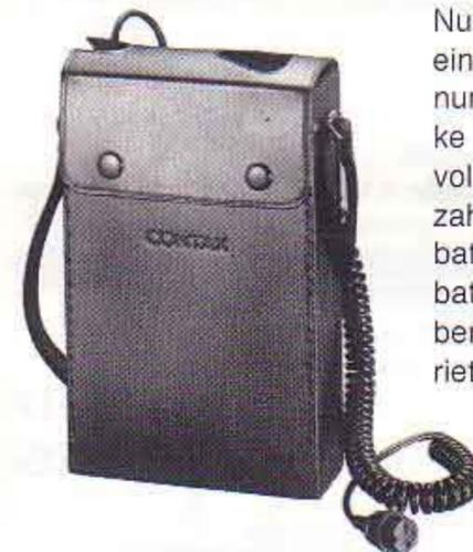
Nur in USA und Kanada lieferbar. Nimmt eine 510 V- oder zwei 210 V-Hochspannungsbatterien auf. Diese besonders starke Stromquelle erlaubt eine Blitzzahl (bei voller Leistung) von 300 bzw. 1200 bei Leitzahl 7. Zusätzlich zu den Hochspannungsbatterien werden noch vier 1,5 V-Mignonbatterien für die Thyristor-Regelelektronik benötigt. Lieferumfang: RTF 510 V-Batterieteil, Tasche, Trageriemen.
