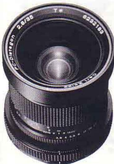
Ein Spezialobjektiv mit besonders großem Bildkreisdurchmesser von 63 mm, entsprechend der für die Perspektivkorrektur notwendigen Objektivverschiebung von 10 mm ab optische Achse. Das Objektiv ist selbstverständlich drehbar gelagert, die Korrektur kann in jeder beliebigen Richtung erfolgen Nahbereichskorrigiert.
