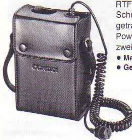
Stromquelle für den mobilen RTF 540-Einsatz. Nimmt 12 Mignonbatterien 1,5 V oder 2 NC-Akku-Sätze auf. Blitzzahl mit Batterien (bei voller Leistung) 100, NC-Akkus 50. In Automatik-Betrieb ca. 300 bzw. 150. Das RTF-Power Pack kann entweder mittels Schulterriemen oder am Gürtel befestigt getragen werden. Lieferumfang: RTF-Power Pack, Tasche, Trageriemen und zwei RTW-Batteriemagazine.
